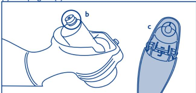
3. Exercer une légère pression vers le bas jusqu'au déclic de la languette de la poignée, qui indique que le montage est correct.
