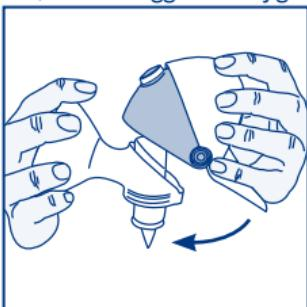
4. Schroef de adapter voor Step Up (6) op de anatomische stolp (2).
