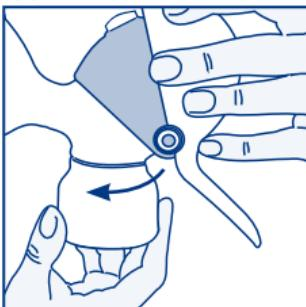
3. Отцепите язычок ручки из гнезда в воронке и потяните вверх до полного отсоединения ручки от анатомической воронки.
