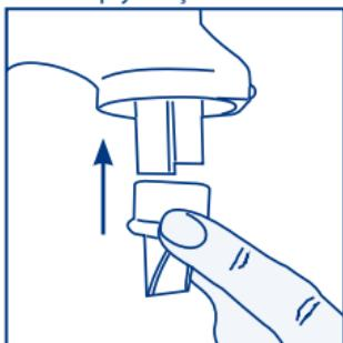
**Dikkat.** Cihazın iyi şekilde çalışabilmesi için geri dönüşü önleyici valfinin uygun olarak konumlandırılmış ve yuvasında tam olarak yerleştirilmiş olduğunu kontrol ediniz.
