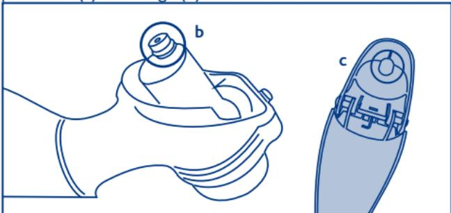
3. Ejercer una ligera presión hacia abajo hasta que se oiga el clic de la lengüeta del mango que indica su montaje correcto.
