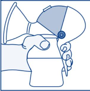
**Let op:** indien de beweging van de handgreep moeilijk is, of niet voldoende vloeibare, wordt aangeraden de zuigerring lichtjes met kinderolie of dergelijke in te smeren (volg hiervoor de aanwijzingen van de paragraaf REINIGING, DESINFECTIE EN ONDERHOUD. Reiniging en onderhoud van de handgreep ).
