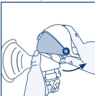
Внимание! Ручка (3) является единственным компонентом, не контактирующим с молоком, поэтому для очистки ее можно просто протирать влажной тканью. При ополаскивании, погружении в воду, стерилизации ручки холодным способом (с помощью стерилизующих средств) и/или горячим способом (паром), используя специальные аппараты или кипячение, нарушается исправная работа молокоотсоса. Рекомендуется периодически выполнять обслуживание в соответствии с указаниями в разделе «Очистка и обслуживание ручки».
