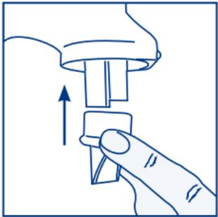
**Attention.** Pour un bon fonctionnement du tire-lait, toujours vérifier que la valve anti-reflux est placée correctement et insérée à fond dans son logement.
