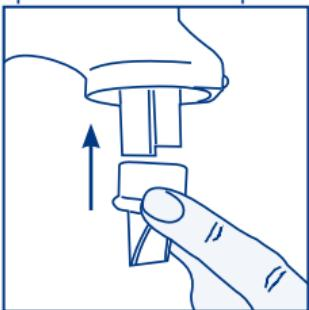
**Let op.** Voor een goede werking van de borstkolf controleert u altijd of de klep voor terugstroombeveiliging goed is aangebracht en volledig op zijn plaats zit.
