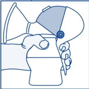
**Atenção:** se o movimento do cabo se tornar difícil ou se este não deslizar bem, é aconselhável lubrificar ligeiramente o anel do êmbolo com óleo para crianças ou semelhante (para efectuar esta operação, siga as indicações do parágrafo LIMPEZA, DESINFECÇÃO E MANUTENÇÃO. Limpeza e manutenção da pega).
