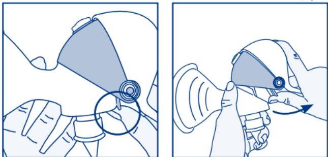
تنبيه: إن الممسك (3) هو الجزء الوحيد الذي لا يتلامس مع الحليب تلامساً مباشراً أبداً. لذا يمكن الالكتفاء بتنظيفه باستعمال قطعة قماش رطبة. قد يتعرض الجهاز للقطع إذا تم غسل الممسك أو تقطيعه بالماء أو إذا تم تعقيمه بالطريقة الباردة باستعمال سوائل التعقيم، أو بالطريقة الساخنة (بالبخار) باستعمال أجهزة خاصة.
