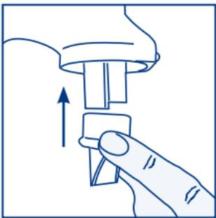
**Warnung.** Für eine einwandfreie Funktionsweise der Milchpumpe stets prüfen, ob das Rückschlagventil richtig und fest in seinen Sitz eingefügt ist.
