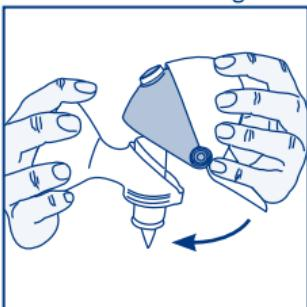
4. Skruva fast adapttern till Step Up (6) på den anatomiskt formade trattens (2).
