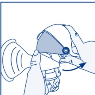
**Dikkat:** Sap (3) sütle temas etmeyen tek parçadır, bu nedenle nemli bir bezle silmeniz yeterlidir. Eğer durulanır, suya daldırılır ya da sterilize edici sıvı ürünler ile soğuk yöntemle ve/veya tasarlanmış özel aletler ile sıcak yöntemle (buharlı) veya doğrudan kaynatarak sterilize edilirse ürünün doğru kullanımı tehlikeye girer. Bakımı düzenli olarak **"Sapın Temizliği ve Bakımı"** bölümünde açıkladığı gibi yapmanız tavsiye edilir.
