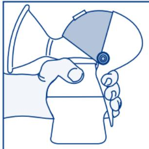
**Warnung:** Wenn die Betätigung des Griffes schwierig sein sollte oder dieser nicht ausreichend gleitet, empfehlen wir den Ring des Kolbens etwas mit Babyöl oder Ähnlichem zu schmieren (dazu die Angaben des Abschnitts REINIGUNG STERILISIERUNG UND WARTUNG. Reinigung und Wartung des Griffs befolgen).
