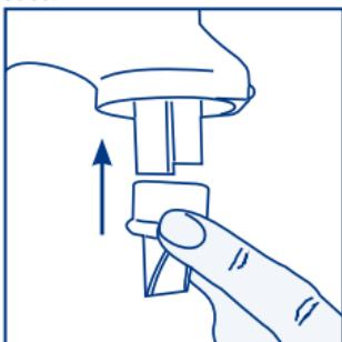
**Viktigt.** För att mjölpumpen ska fungera bra ska man alltid kontrollera att överfyllningsskyddet sitter på rätt sätt och ända ned i dess säte.
