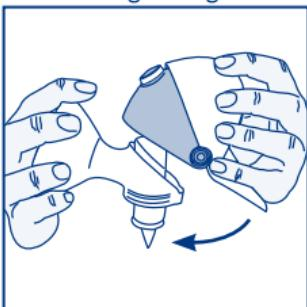
4. Den Adapter für Step Up (6) an die anatomische Saugglocke (2) anschrauben.
