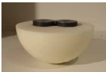
Figura 1 Semisfera utilizzata per i test con caratteristiche di una testa di bambino di 9 mesi.
